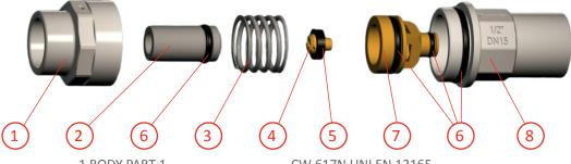
1 BODY PART 1 ......CW 617N UNI EN 12165 2 SEAT...... AISI 304 3 SPRING ......AISI 302
