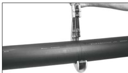
Řez potrubí ruční rotační rezačkou
