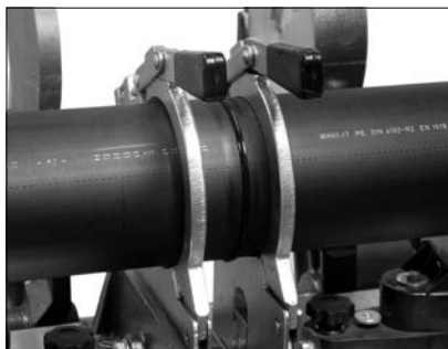
Chladnutí svařeného spoje
