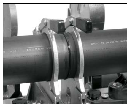
Chladnutí svařeného spoje
