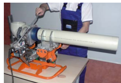
Upnutí do přípravku a vycentrování, poté nahřívání
