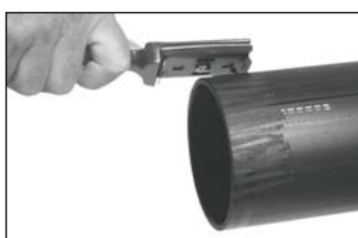
Oškrabání konců potrubí ruční škrabkou
