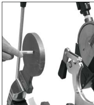
Kontrola teploty svařovacího zrcadla pyrometrem
