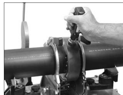
Srovnání konců potrubí hoblíkem
