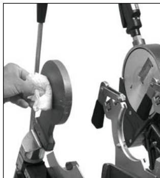
Čistění svařovacího zrcadla – dbejte na to, aby nedošlo k poškození teflonové vrstvy
