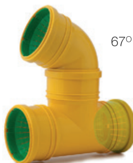
KDR 23 trójnik drenarski uniwersalny kątowy łączy rury drenarskie od \varnothing 72 do \varnothing 100 mm
